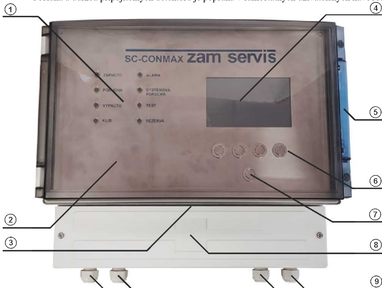
Obr. 1 - Čelní pohled - 1) Stavové signálky 2) Čelní panel 3) Výrobní štítek 4) 5" LCD displej s dotykovou vrstvou 5) Otvírací madlo 6) Ovládací tlačítka 7) Kvitovací tlačítko 8) Víko svorkovnicového prostoru 9) Kabelové vývodky 8x M20
